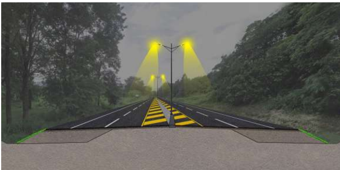
รูปตัดแสดงเสาไฟฟ้าแสงสว่าง เกาะกลางแบบแท่งคอนกรีต (Barrier Median)
