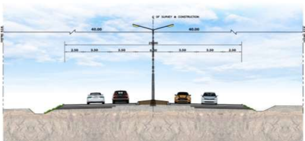
รูปที่ 2.6.2-4 รูปตัดทางหลวงของโครงการ กม.95+300 - กม.96+588
