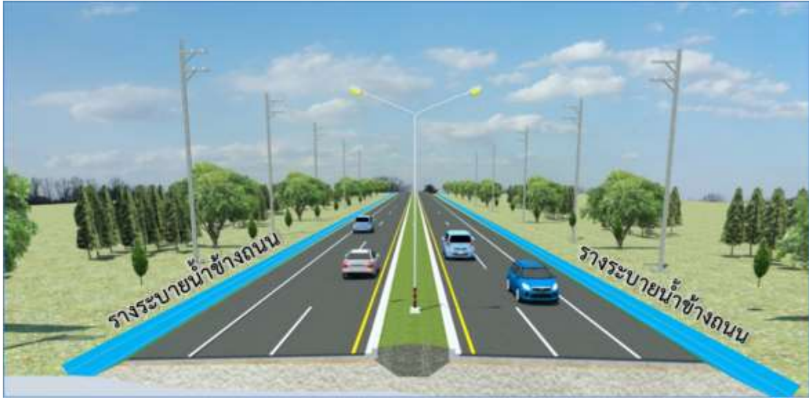
รูปที่ 2.6.8-3 รูปตัดแสดงการระบายน้ำระดับดินของโครงการ (กรณีเกาะกลางแบบยก (Raised Median))
